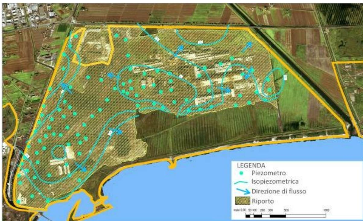
L'intervento proposto per la messa in sicurezza della falda presente nei terreni di riporto nella macroisola nord prevede la regimazione idraulica delle aree demaniali in concessione alla Lucchini S.p.A. in A.S., attualmente interessate da impianti di lavorazione e da aree di stoccaggio di materie prime, di sottoprodotti e di rifiuti industriali.
