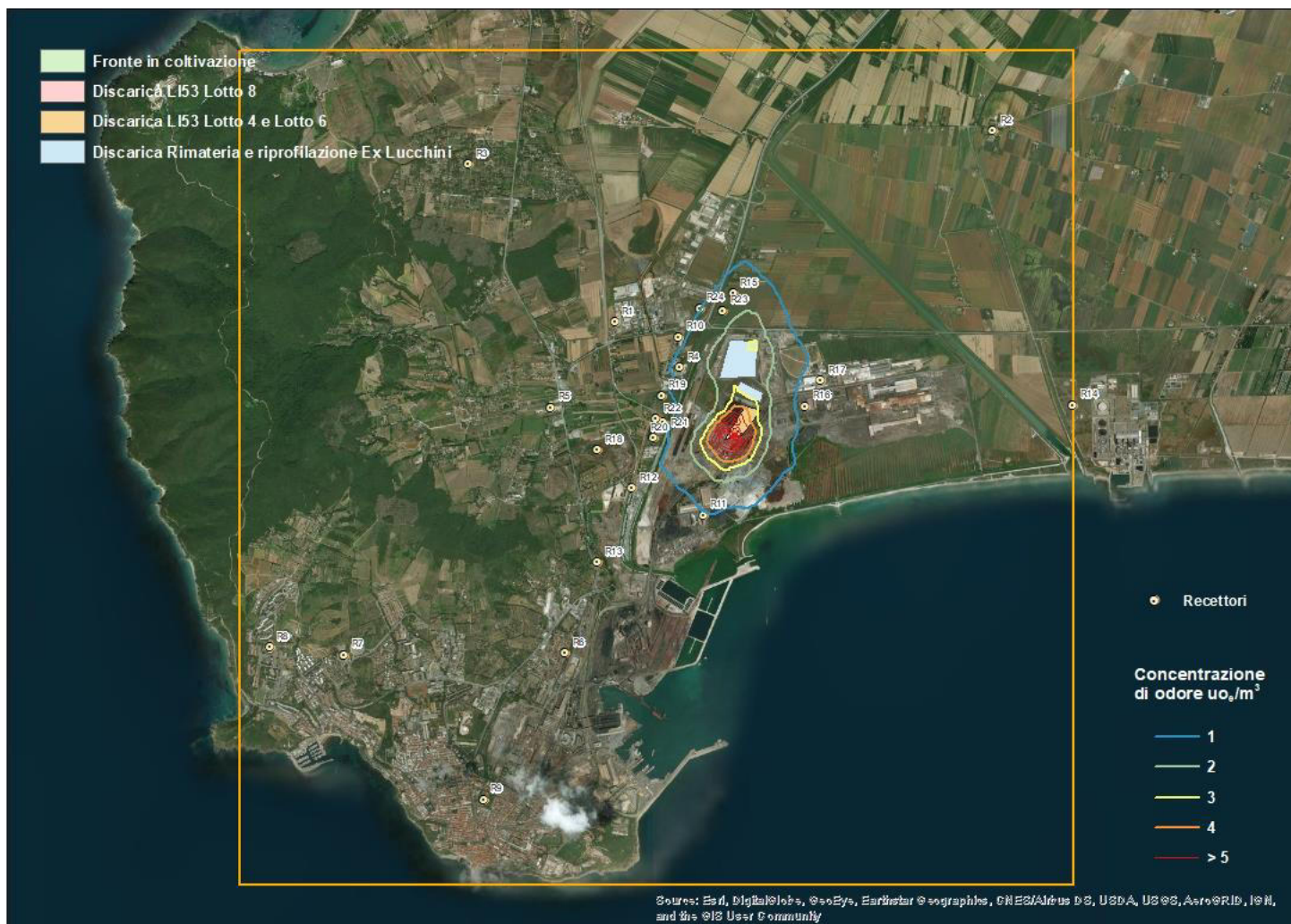
Figura 2.8 Scenario II Medio di progetto: mappa del 98° percentile delle concentrazioni massime orarie di picco di odore sull'intero periodo
